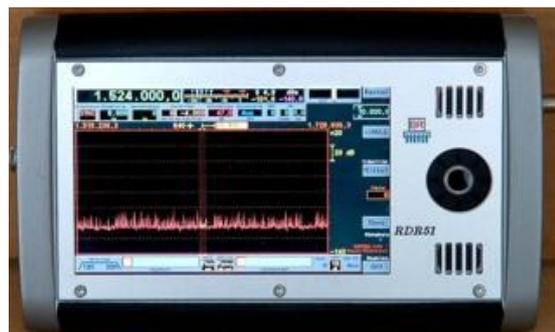
Some free space here so here is a picture of the Reuter pocket. *Der Reuter Pocket enthält die vollständige, Spektrum-basierte RDR-Elektronik der neuesten Generation in einer low-Power Version. Der eingebaute Li-Akku reicht für ca. 4 Betriebsstunden bei voller Funktionalität (RX), mit Stromsparfunktionen deutlich länger.*
