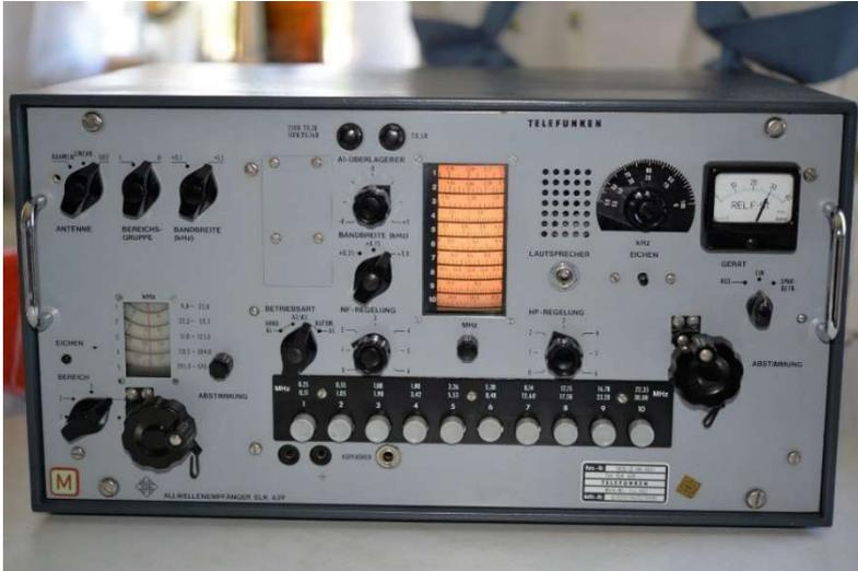
**Allwellenempfänger Telefunken ELK 639.** Der Allwellenempfänger ELK 639 stammt aus den Jahren 1969/70 und ist als Wach- und Betriebsempfänger bei festen und beweglichen Funkstellen geeignet. Der Frequenzbereich von 9,8 kHz bis 30 MHz ist in getrennte 2 Gruppen unterteilt: Gruppe I von 9,8 bis 570 kHz in fünf Teilbereichen und Gruppe II von 250 kHz bis 30 MHz in 10 Teilbereichen.
