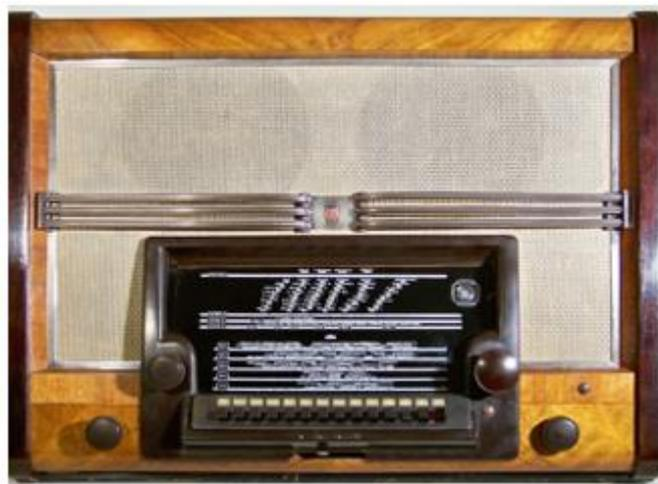
Philips 990X är den största och dyraste bordsradien från Philips och tillverkades 1939/40. Den väger 30 kg. Den har två KV-band (13,6-170 m).
