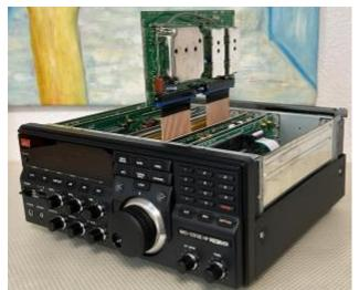
Weil die NRD-5xx Empfängerreihe von professionellen Empfängern abgeleitet wurde, sind sie Modular aufgebaut. Das bedeutet, im Gerät stecken mehrere Module. Um diese ausserhalb vom Gerät reparieren und testen zu können, bedarf es einer Platinenverlängerung, damit die betroffene Platine aus dem Gerät ragt, sie aber trotzdem mit dem Rest des Gerätes verbunden ist.
