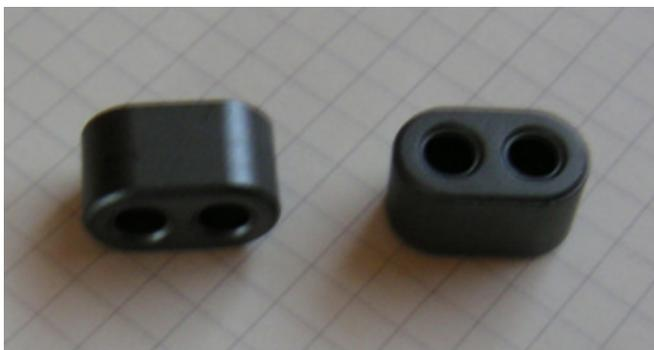
Min trafo består av 2 st N30 tvåhålskärnor lindade med 2 varv på primären (50 ohm) och 6 varv på sekundären, vilket ger en omsättning på 50:450 ohm, vanligt då man talar om Bäverantenn.
