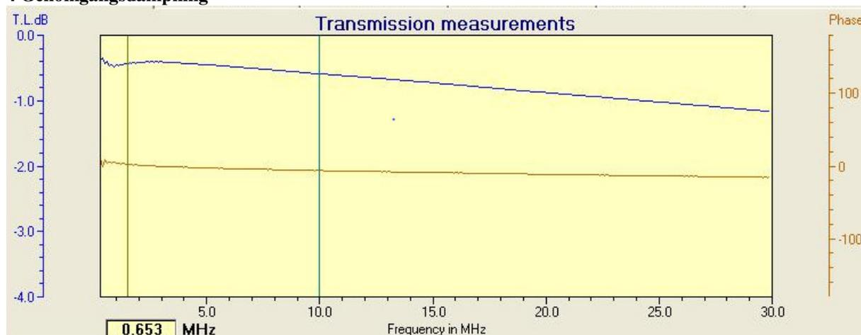
Dämpningen är 0,4dB vid 1,5MHz och 0,6dB vid 10MHz, för att sedan sjunka till ca 1dB vid 30MHz. Eftersom mätningen görs med två transformatorer "back-to-back", blir dämpningen per transformator 0,2, 0,3 resp. 0,5dB. Detta får anses vara bra och fullt användbart!
