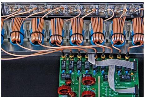
Mein "Custom Production" remoteQTH.com Antennenum-schalter, 9 Antennen via Internet schaltbar, Voverstärker und Bandpässe für Mittelwelle und Tropenband - und jede Menge QRM Filterung.
