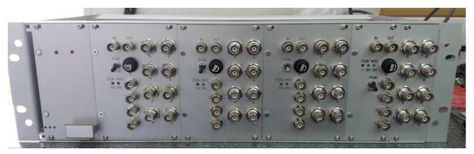
Hier ein Bild des neuen Selbstbauverteilers, Entwicklung von OM Joachim gemeinsam mit OM Frank Wornast. Dies ist Joachims Versuchsträger, enthält von links: Spannungs- und Stromanzeige, zwei Spannungsausgänge, HF-Generatoren für 1 MHz und 8 MHz, darüber eine Impedanzanpassung. Dann folgt ein Pi-Filter, mit dem sich Drahtantennen direkt anpassen lassen, ein VHF-Verteiler für 4 Teilnehmer sowie zwei Verteiler für VLF bis KW für je 12 Teilnehmer.
