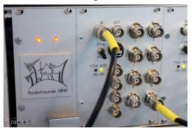
In eigener Sache: Es kommen bisweilen Anfragen zu unserer neuen Antennenverteilanlage. Die Platinen dazu wurden in Anlehnung an die alte Verteilanlage AVV01 von RFT aus der DDR (80er Jahre) von OM Frank Wornast DD3ZE entwickelt. Diese haben wir in 19"-Baugruppenträger eingebaut, wie sie hier auf den Bildern zu sehen sind.
