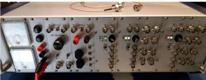
Neuigkeiten von der Verteilanlage. Am Wochenende haben wir zu Dritt den ersten Baugruppenträger mit 4 Verteilkassetten (1 auf 12) und Netzteil fertiggestellt. Der Zweite erfolgt in Kürze, ebenso der Einbau in Rackcases zum sicheren Transport.
