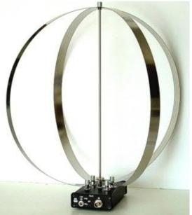
aus. Fernsteuerbare Empfänger ("Internet-Receiver") können nun mit einer ebenfalls fernsteuerbaren, hochsensitiven und richtungsdrehbaren Loop-Antenne ausgestattet werden.
